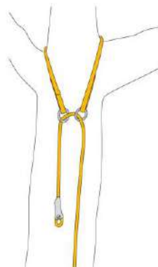
Fig. 8 - Ancoraggio passante per corda raddoppiata
