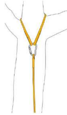
Fig. 5 - Ancoraggio della fune con dispositivo a strozzo passante
